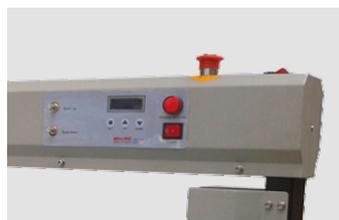
O dispositivo de controlo por infravermelhos ajusta com precisão a temperatura, possibilitando um laminado com velocidades e materiais diferentes, garantindo um acabamento sem bolhas e sem vincos.
